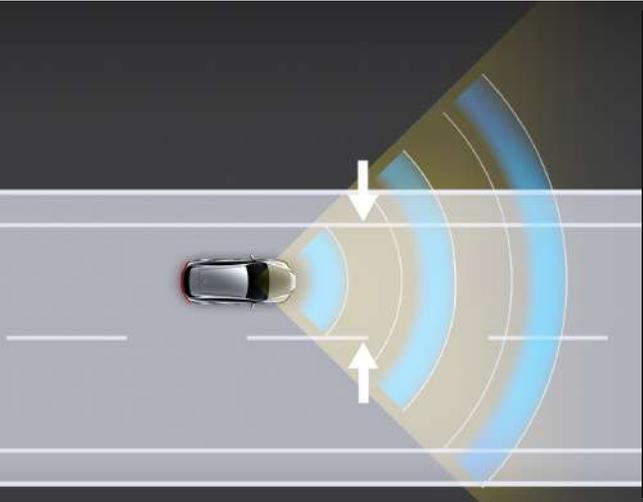
**ALERTA DE SALIDA DE CARRIL CON ASISTENCIA DE DIRECCIÓN** Este sistema\* utiliza una cámara para supervisar las marcas de carril visibles. Si se detecta una salida involuntaria de carril a velocidades superiores a 32 mph, el sistema está diseñado para advertirle para que pueda volver a dirigir el vehículo al carril, e incluso puede tomar medidas correctivas leves para ayudar a mantenerlo dentro de su carril visiblemente marcado.
