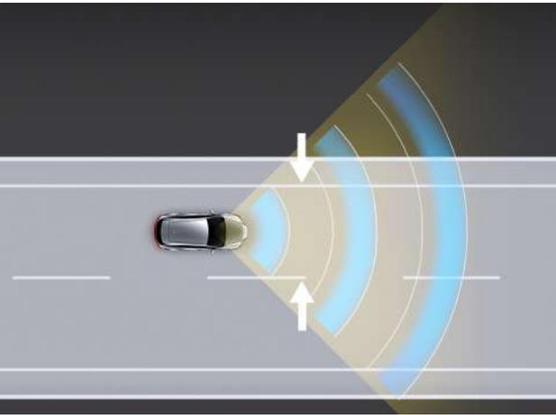
**ALERTA DE SALIDA DE CARRIL CON ASISTENCIA DE DIRECCIÓN** Este sistema\* utiliza una cámara para supervisar las marcas de carril visibles. Si se detecta una salida involuntaria de carril a velocidades superiores a 32 mph, el sistema está diseñado para advertirle para que pueda volver a dirigir el vehículo al carril, e incluso puede tomar medidas correctivas leves para ayudar a mantenerlo dentro de su carril visiblemente marcado.
